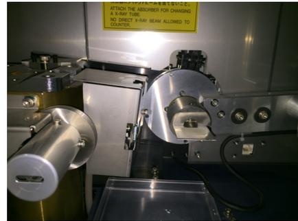
Figura 4 – Amostra curada e já pulverizada disposta no porta-amostras do difratômetro (DRX), convencional, modo reflexão, da FATEC-SP.
