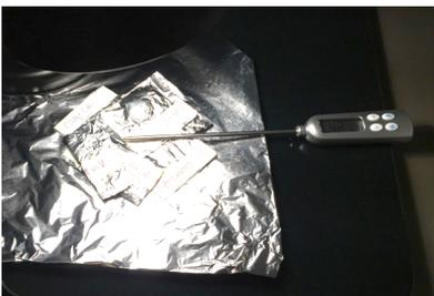
Figura 2 – À esquerda amostras envelopadas com folha de alumínio para melhor condução do calor. À direita termômetro para acompanhamento da temperatura de aquecimento.
