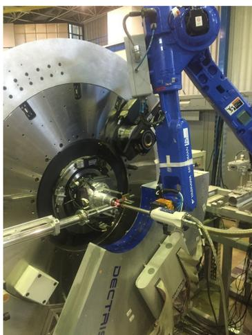
Figura 5 – Difratorômetro da Estação XRD1 do LNLS, amostra encapsulada em tubo capilar e com aquecimento externo por jato de ar quente. Hidratação e coleta de dados de forma dinâmica (modo transmissão).
